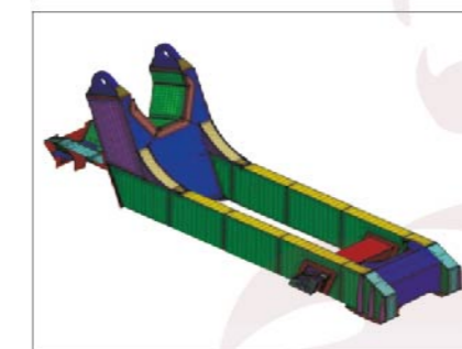
Анализ рамы методом конечных элементов
